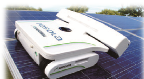
自走ロボットクローラー部: 自走式太陽光パネル清掃ロボット「リソラ」(シンフォニアテクノロジー(株))
